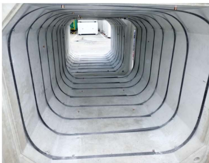
施工性試験 (ボックスカルバート)
